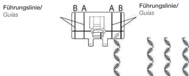
3. Die zwei Reihen mit der Führungslinie A ausrichten und dann die nächste Reihe nähen.
